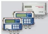
Счетчик-расходомер комплектуется выносным (до 300 м) блоком индикации БИ-03 с внешним ( $\pm 12$  В) питанием и архивированием результатов измерений и нештатных ситуаций. Предусмотрено подключение в локальные сети сбора информации, в том числе с применением GSM/GPRS и Ethernet-каналов связи
