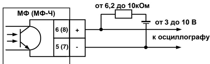
Рисунок 7.1 – Контроль выходного сигнала
